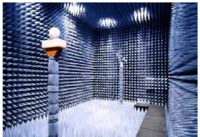
〈ECCOSORB HPYを使用した電波暗室の一例〉
